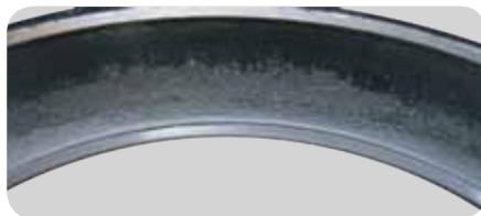
contacto metálico entre los elementos rodantes y el camino de rodadura.
