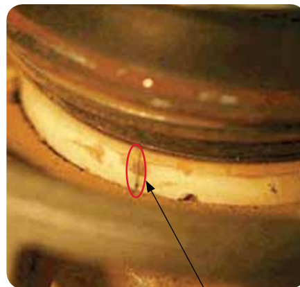
Aro de Fricción de Cerámico. Fisurado
